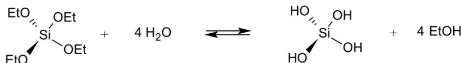
Figure 110 : Schéma réactionnel de l'hydrolyse du tétraéthoxysilane.
