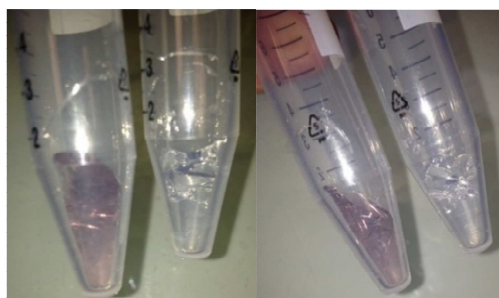
Figure 165 : Photos des matériaux obtenus avec gélification en centrifugation, le matériau blanc étant bien sûr l'incolore et le violet le dopé en bipyramides
