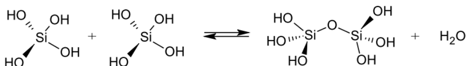
Figure 111 : Schéma réactionnel de la condensation de deux groupements silanols : réaction d'oxolation.
