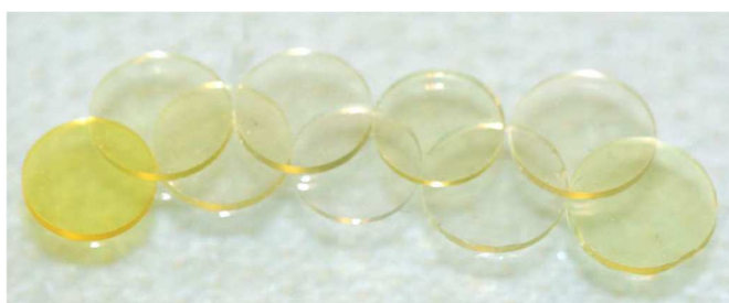
Figure 120 : Matériaux dopés PE2 polis avec des concentrations allant de 0,1 mM pour le plus incolore à 400 mM pour le plus coloré.
