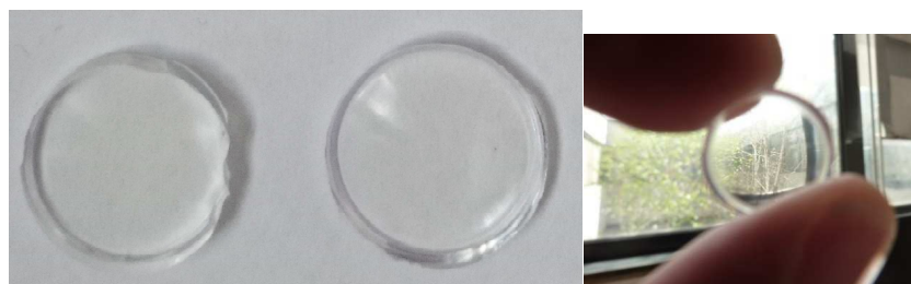
Figure 123 : Matériaux dopés en trifluorène, à gauche 1mM et à droite 10mM (Image à gauche) et transparence du matériau à 10 mM (image de droite).
