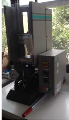
Figure 161 : Presse utilisée pour la réalisation des assemblages des matériaux
