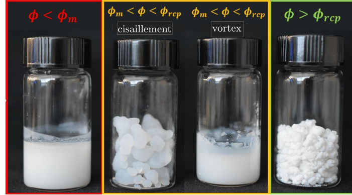
FIGURE 4.2 Suspensions de silice à différentes fractions massiques \phi . Pour \phi < \phi_m \simeq 0.24 , la suspension obtenue par un mélange mécanique simple est homogène, \phi_m est appelée fraction massique de blocage. Pour des fractions massiques \phi > \phi_m , le cisaillement mécanique conduit à la formation de granules. En faisant vibrer la suspension à l'aide d'un vortex, il est possible d'obtenir un mélange homogène pour des fractions massiques 0.24 \simeq \phi_m < \phi < \phi_{rcp} \simeq 0.44 . \phi_{rcp} est la fraction massique limite pour laquelle les particules sont arrangées le plus proche possible les unes des autres. Au-delà de cette fraction limite \phi_{rcp} , les particules mélangées au solvant ne forment plus une suspension homogène. Images issues d'une communication privée de C. Garat et G. Ovarlez.
