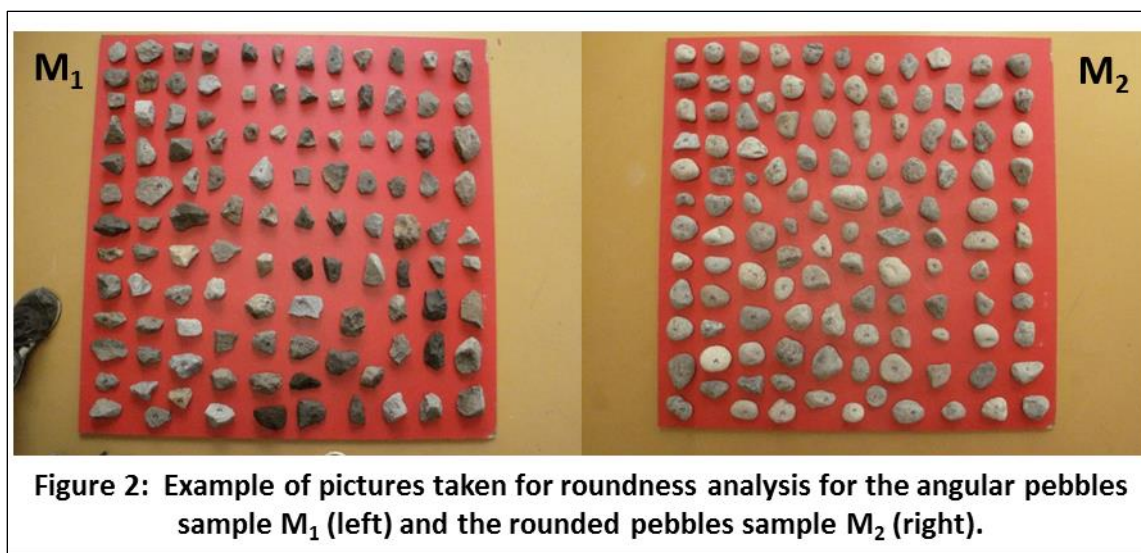
Figure 67. Exemple de photographies pour l'analyse de l'éroulé des échantillons anguleux M_1 (à gauche) et éroulé M_2 (à droite).
