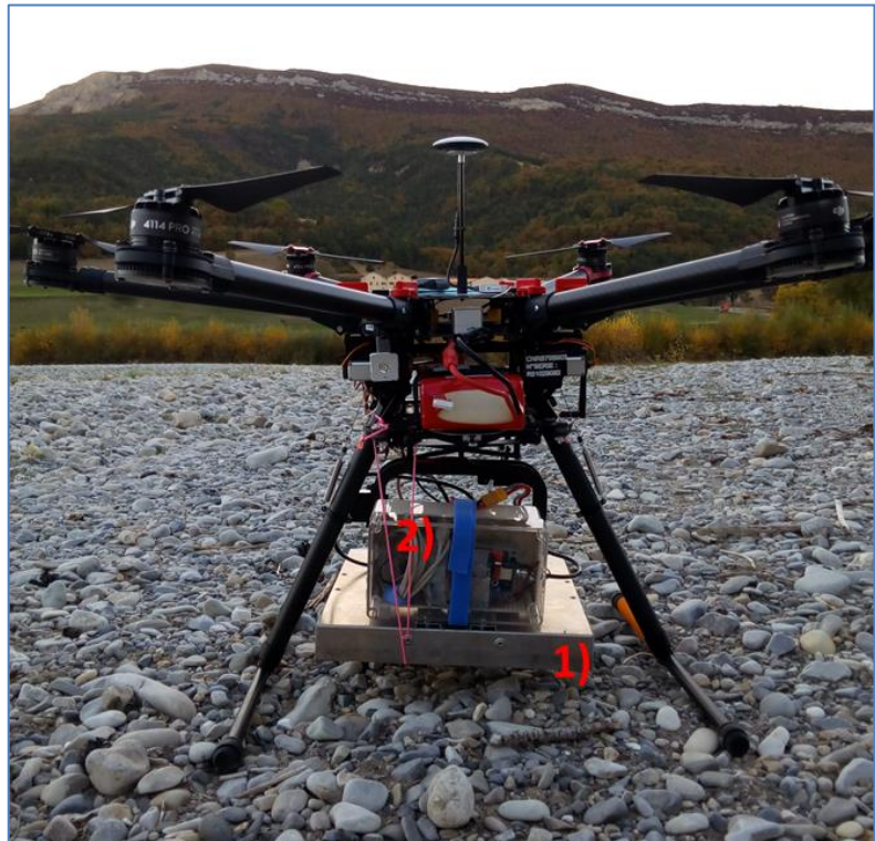
Figure 82. Adaptation du système de détection des transpondeurs a-UHF sur un drone.
