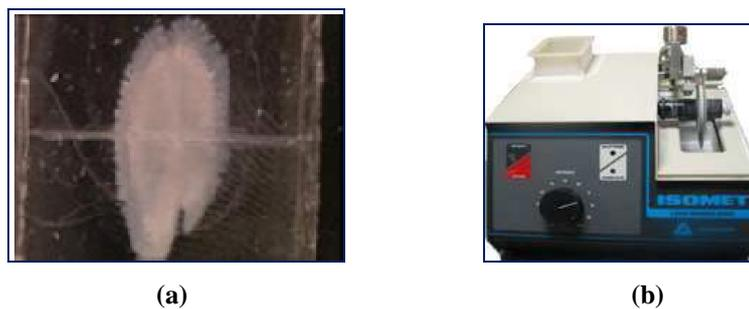
Figure 28. Images d'otolithe inclus dans de la résine avec le plan de coupe indiqué (a) (photo W. Ndiaye) et d'une Tronçonneuse Isomet de Buebler (b) (In: copyright IFREMER).
