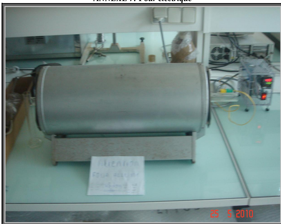
ANNEXE 7: Four électrique
