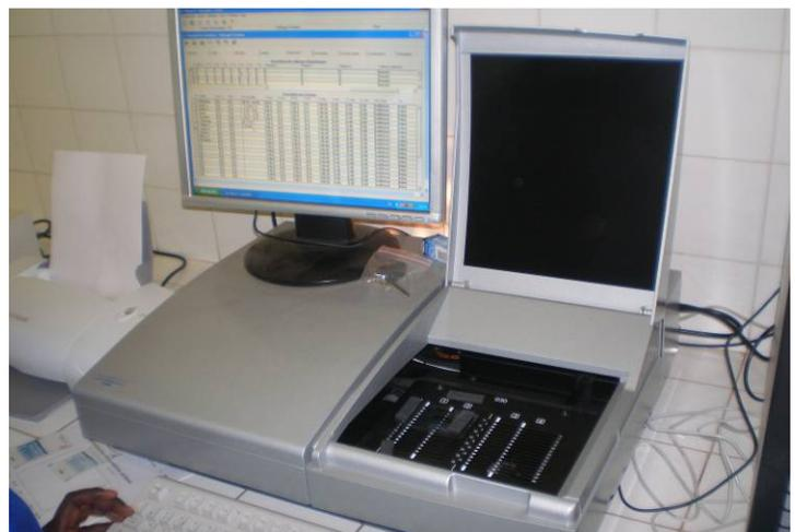
**Figure 24** : Lecture au densitomètre PROG HYDRAGEL PROTEINE
