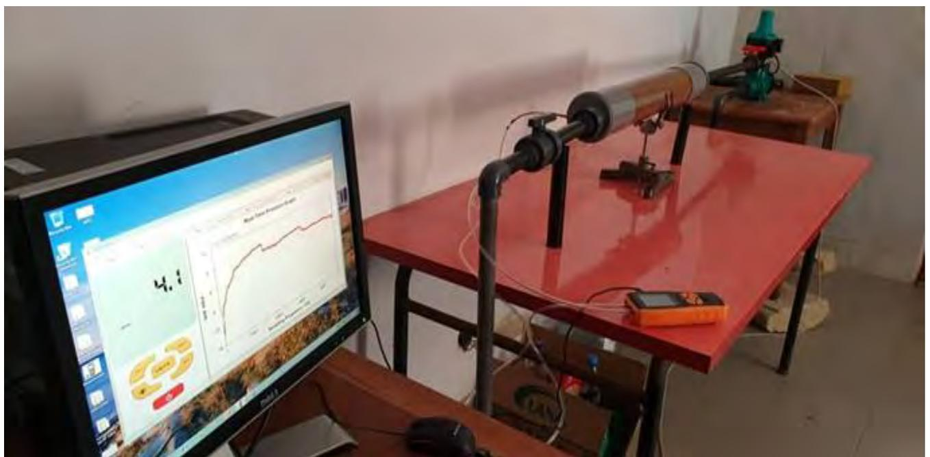
Figure 4.2.2 : montage expérimentale (milieu poreux saturé, mesures).
