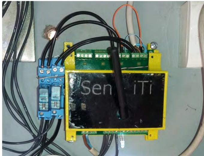
Figure 114: première version du prototype, installé au poste Ecole Mariste
