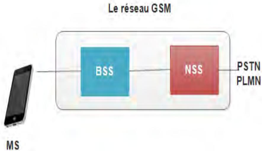
Figure 1.1. Architecture de base du réseau GSM
