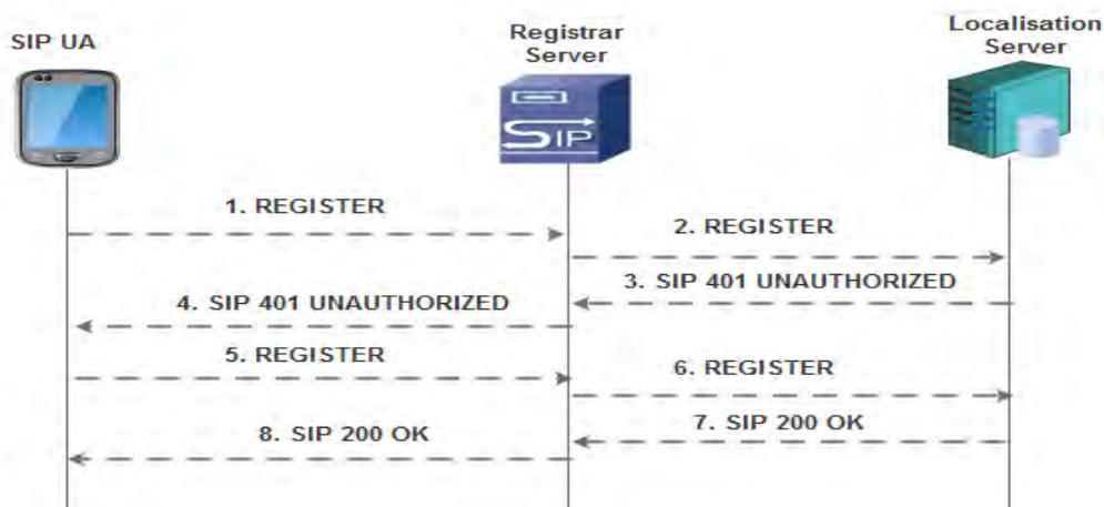
Figure 3.1. Procédure d'enregistrement SIP REGISTER
