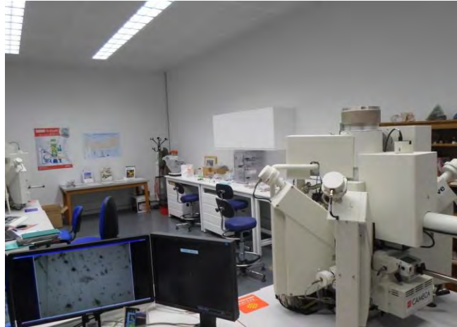
Figure 10 : Microsonde électronique Cameca SX Five
