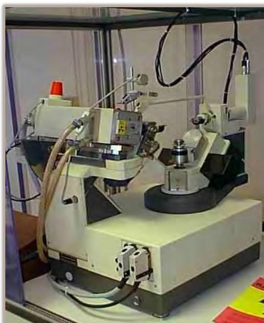
Fig. 2.3.a: Diffractomètre Nonius 4 cercles
