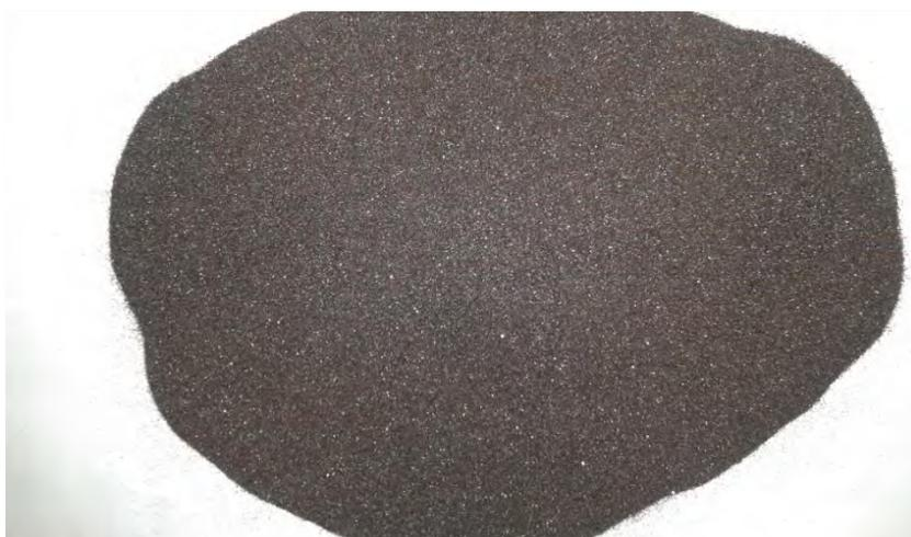
**Figure II. 1** : Echantillon de *sable titanifère utilisé comme photocatalyseur*
