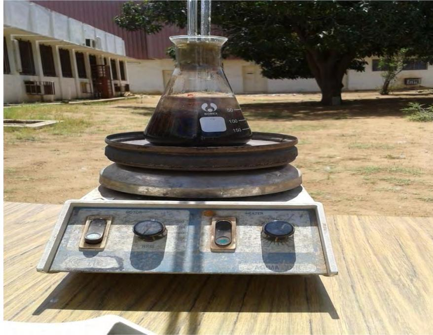
**Figure II. 8 : photoréacteur en Batch**
