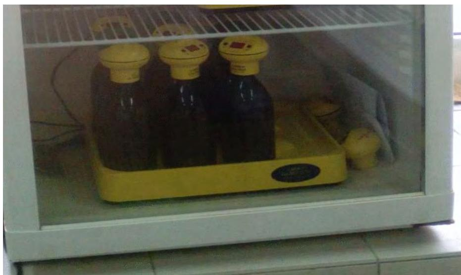
**Figure II. 14 : Flacons DBO surmontés d'un oxymètre dans l'armoire d'incubation**
