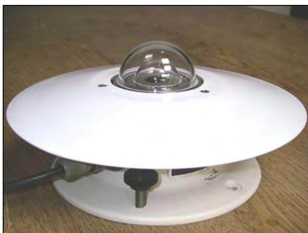
**Figure II. 11 : le pyranomètre**
