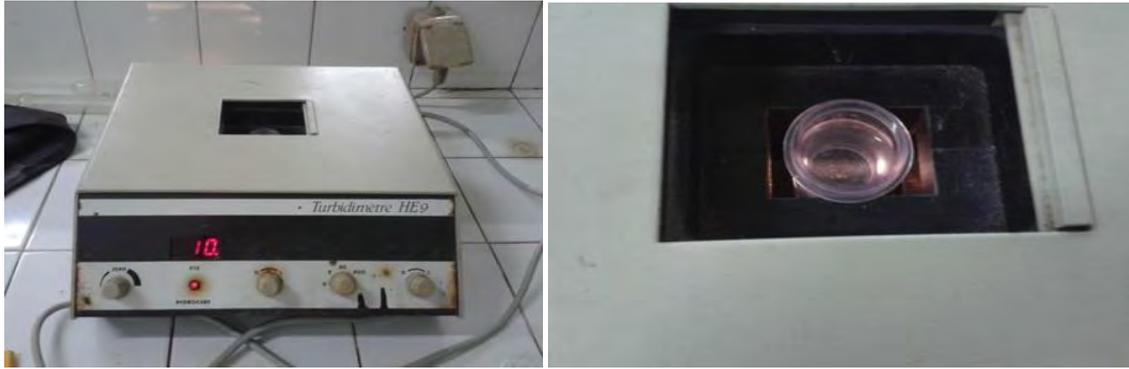
**Figure II. 12 : Turbidimètre HE9**
