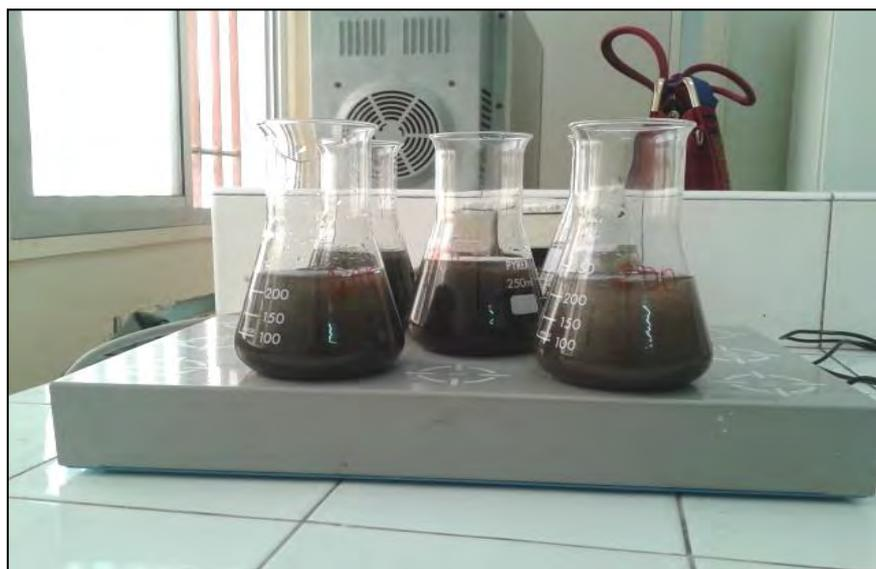
**Figure II. 6 : Dispositif expérimental de l'adsorption en régime statique.**
