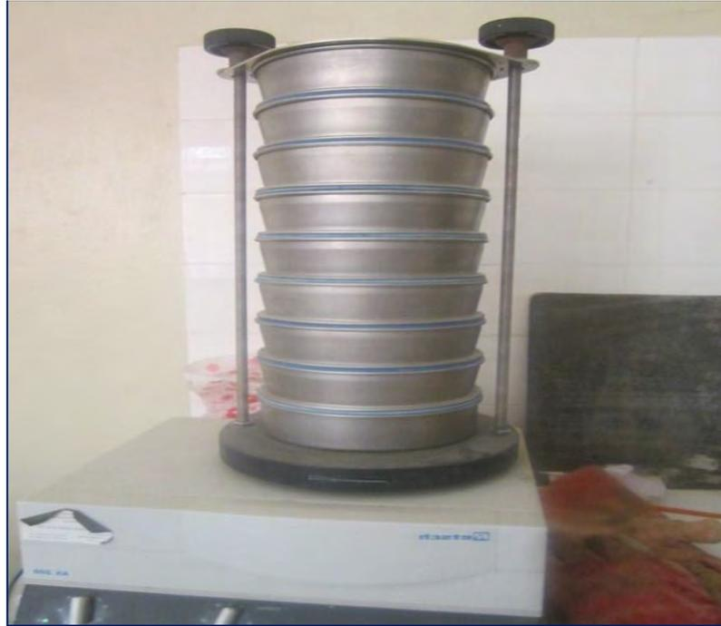
**Figure II. 2 :** Dispositif expérimental de l'analyse granulométrique
