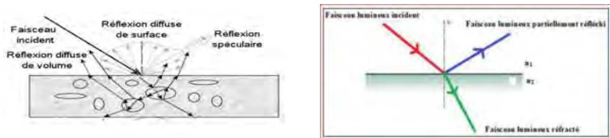
Figure II.2 : Description schématique de la propagation d'un rayon incident et de la réflexion d'un rayon lumineux.
