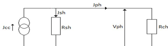
**Figure II.9** : Circuit équivalent de la photopile (générateur de courant)
