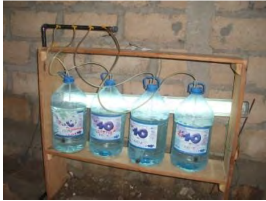
Figure 20: Dispositif pour la culture des micro-algues
