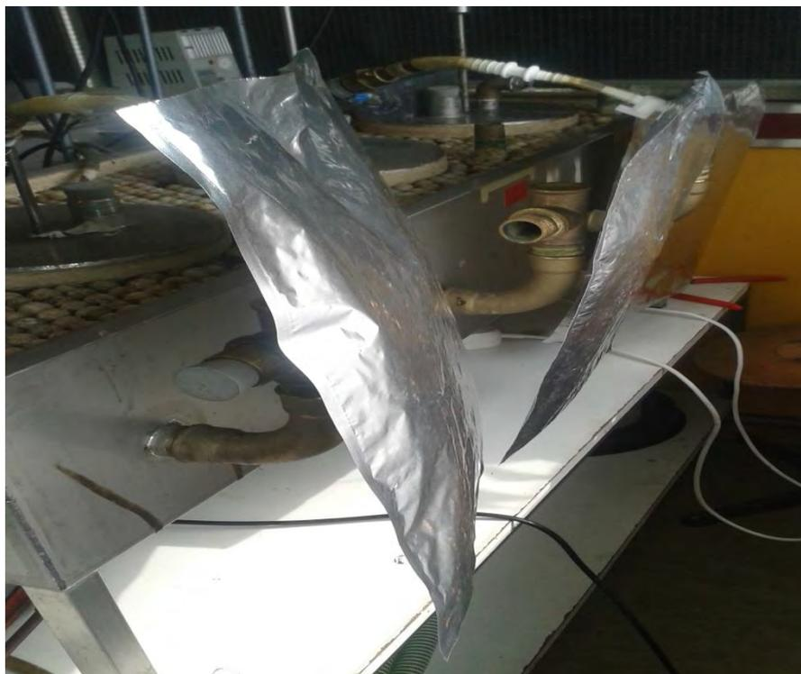
Figure III-9 : Récupération du biogaz.
