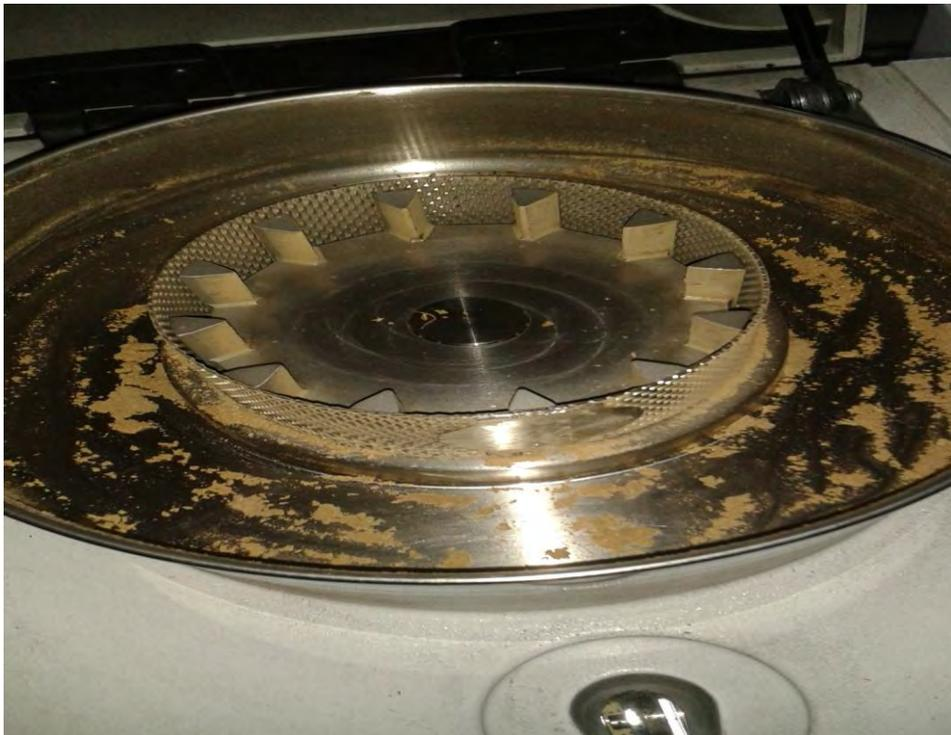
Figure III-5 : Vue interne du broyeur centrifuge.
