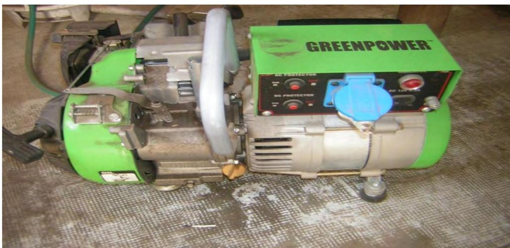
Figure A.II.1 : Moteur à biogaz de 700 W (CERER)
