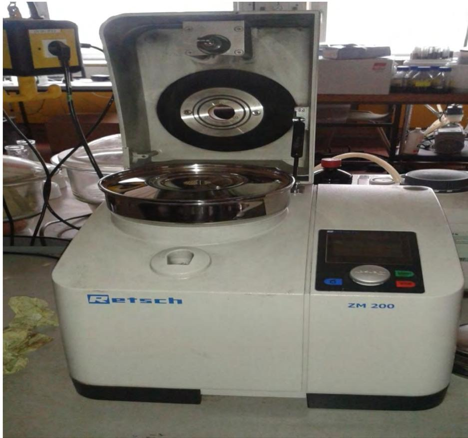
Figure III-4 : Le broyeur centrifuge.
