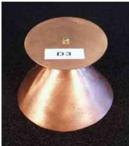
FIGURE 2.8 – Exemple d’une réalisation de l’antenne discone
