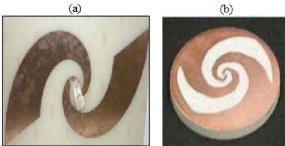
FIGURE 2.1 – Antenne spirale logarithmique [3] (a) : antenne réalisée en imprimant les bras métallisés sur un substrat ; (b) : antenne spirale logarithmique à fente
