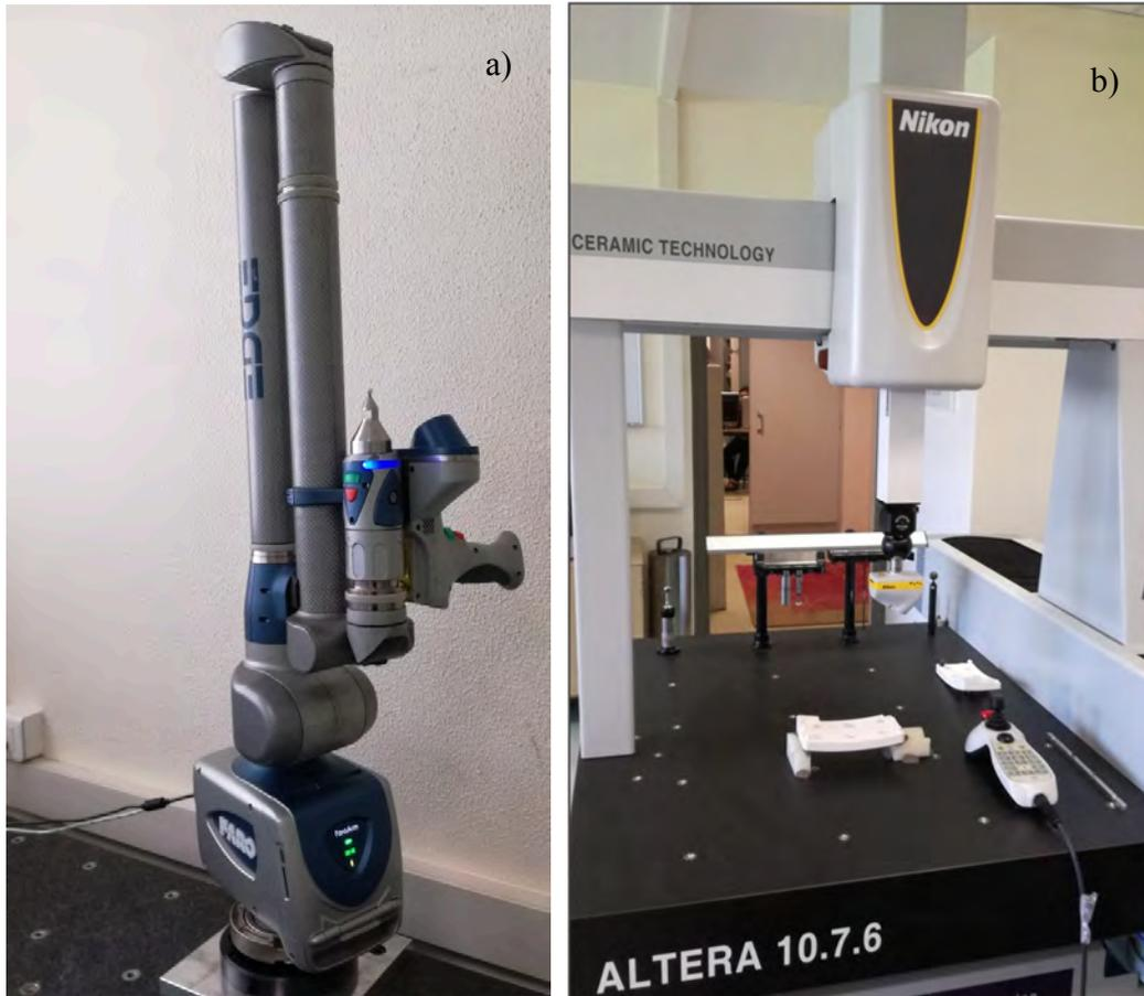
Figure 1. 2 - MMT bras portable (a) et MMT fixe (b) équipées de deux technologies
