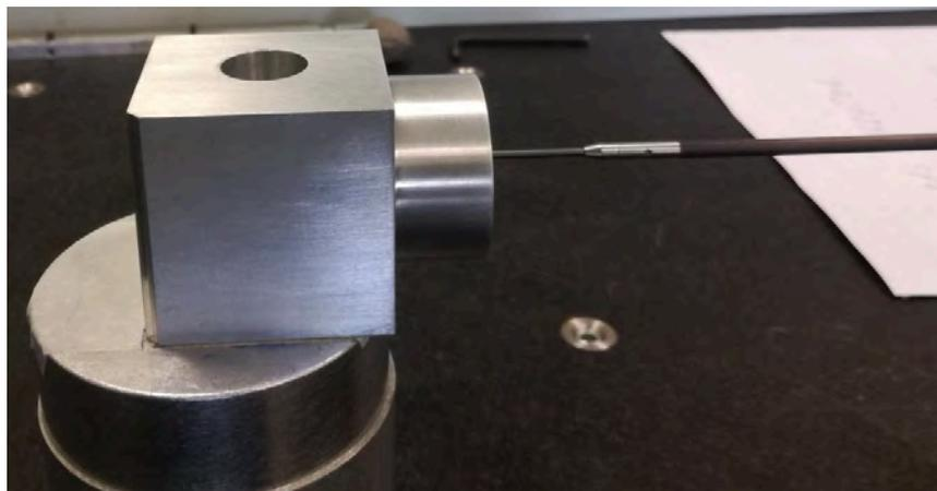
Figure 4. 8 - Dégauchissage de la pièce
