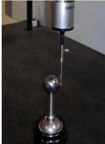
Figure 2.3 - Mesure de points à côté de la sphère étalon
