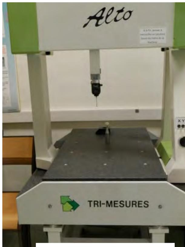
Figure 1. 1 - MMT avec contact
