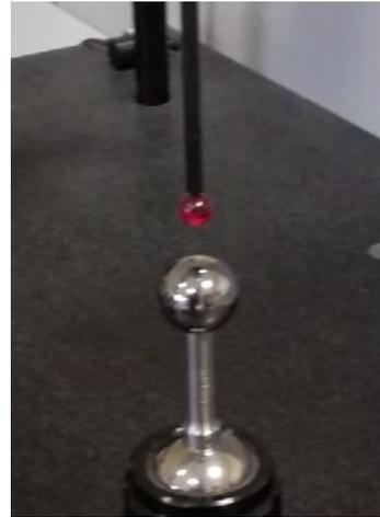
Figure 2.3 - Mesure d'un point au sommet de la sphère étalon
