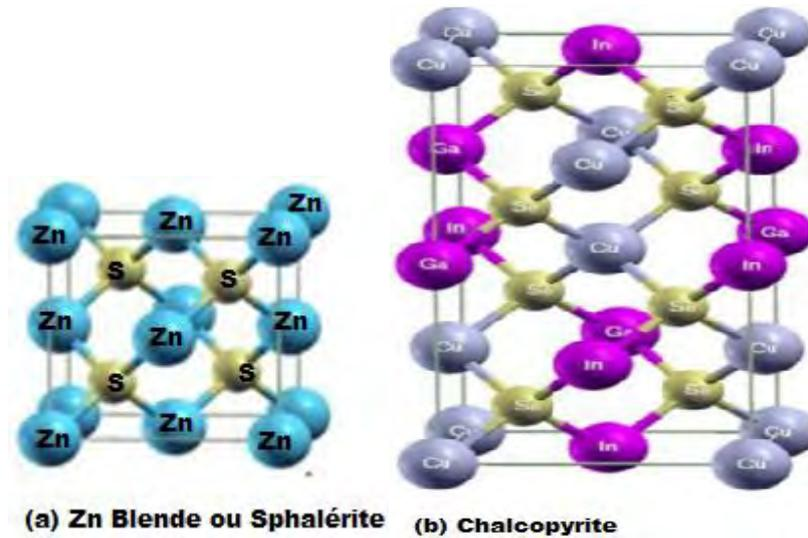
Figure I 3 : Structure cristalline de type zinc de blende et celle du CIGS [8].
