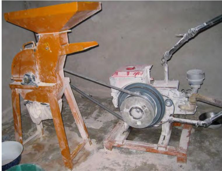
FIGURE C.2 – Structure du moulin à poulie-courroie
