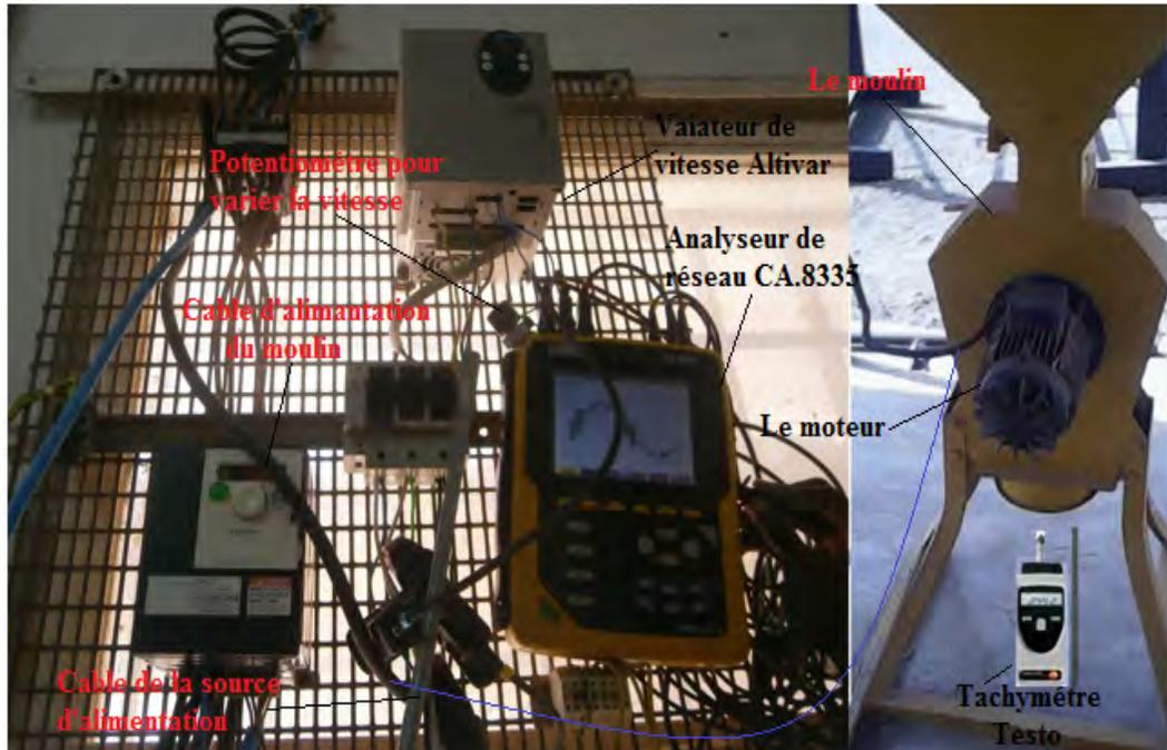
FIGURE 3.13 – Banc expérimental du système
