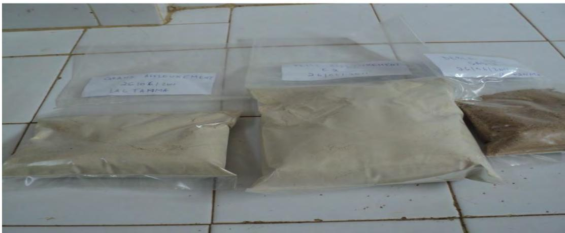
**Figure 19:** Echantillons de substances inertes dans les sachets en plastique polyéthylène (granulométrie inférieure à 0,3mm)
