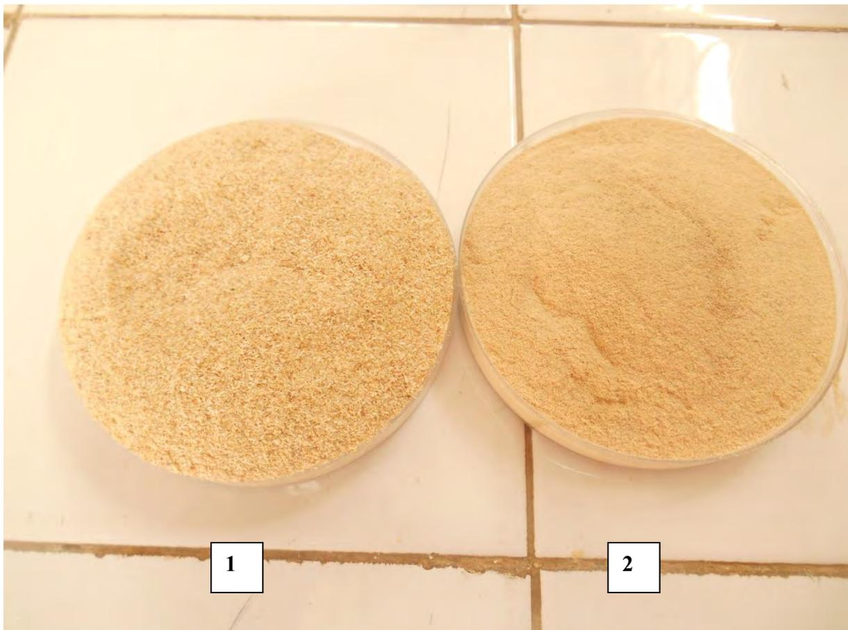
Broyat des rafles d'épis de maïs; en (1) diamètre 0,5 mm et en (2) diamètre 0,2 mm
