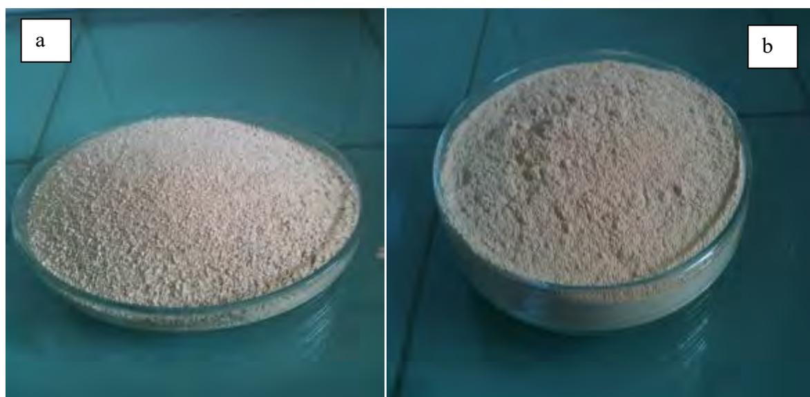
**Figure 27:** Substances inertes moulues et tamisées aux granulométries 1mm (a) et 0,3mm (b)
