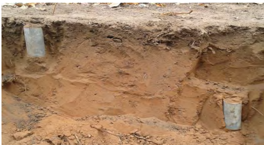
Photo 8. Technique de prélèvement d'échantillons par la méthode au cylindre
