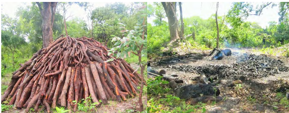
Photo 6. Installation de meule traditionnelle Photo 7. Carbonisation dans la FCP
