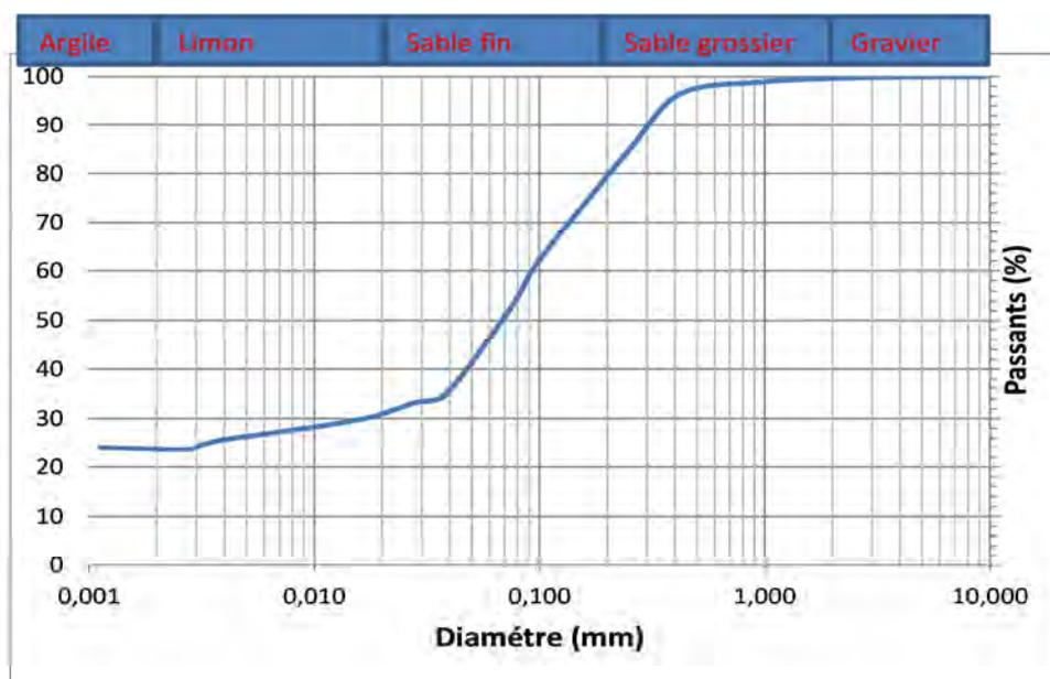
Figure 16 : Courbe granulométrique de l'échantillon SP N1 Centre
