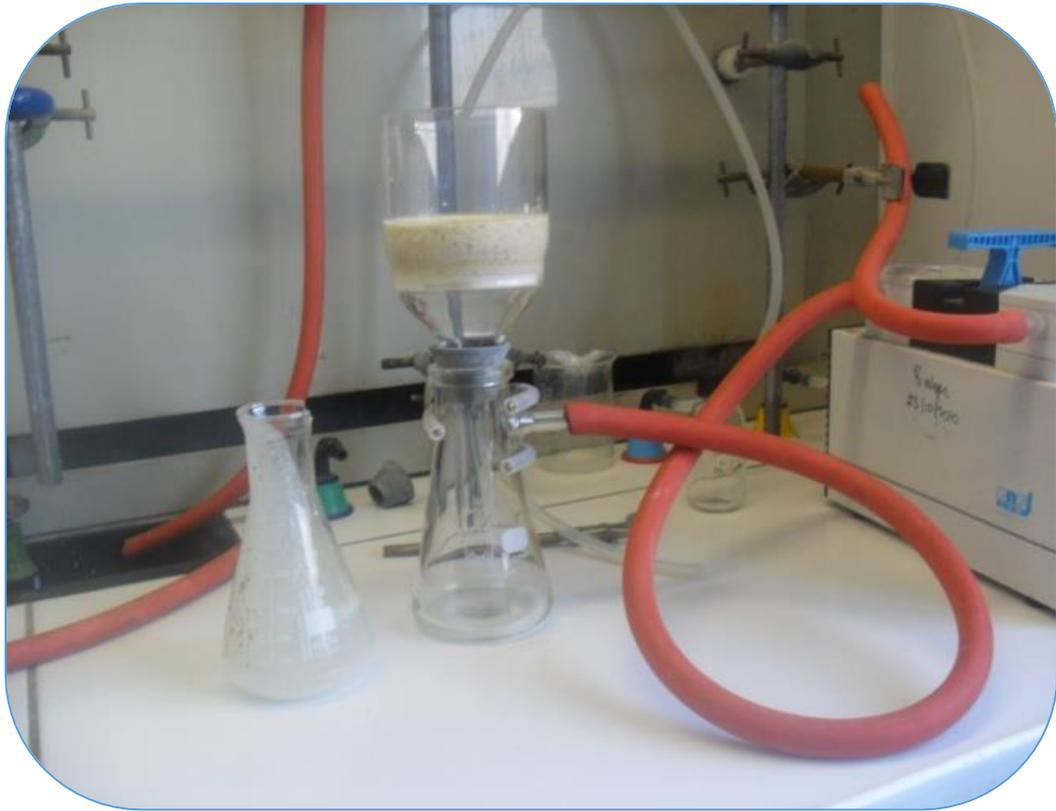
**Photo 14 :** *Filtration sur fritté sous vide avec une pompe à membrane*
