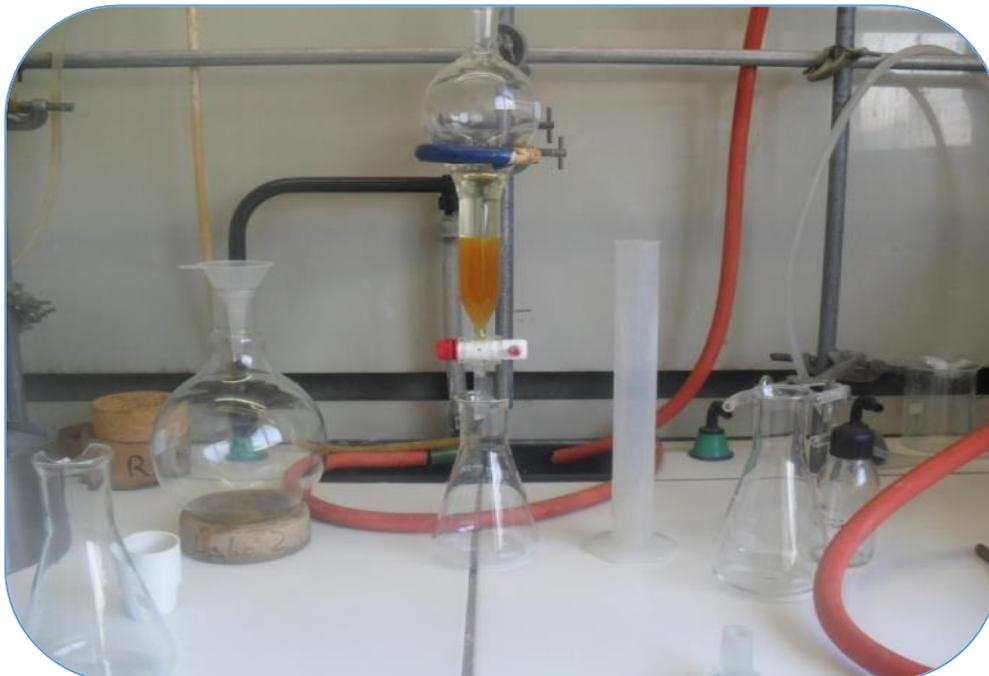
**Photo 11** : *Extraction liquide- liquide au MTBE du concentrat*
