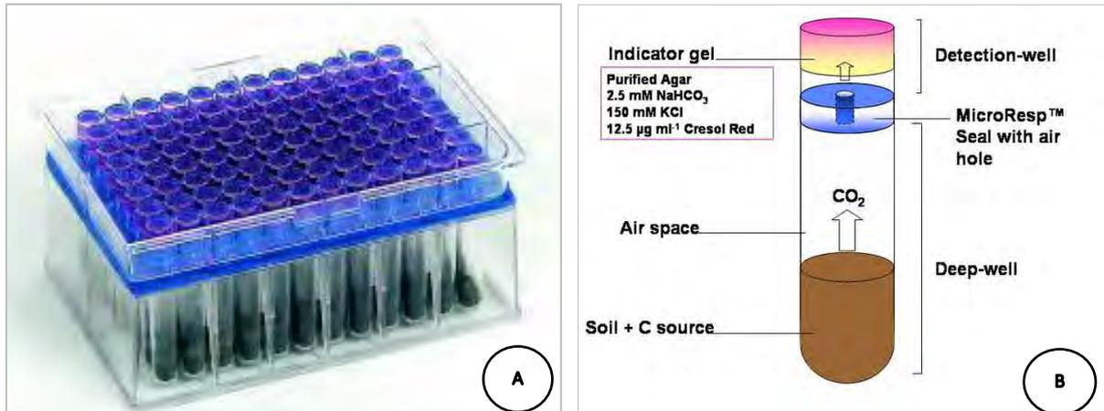
Figure 8: Principe de la technique MicroResp™ (crédit photo : [www.MicroResp.com](http://www.MicroResp.com)). (A) plaque de détection montée sur une plaque à puits profonds contenant les échantillons de sol par l'intermédiaire d'un joint (en bleu). (B) Zoom individuel sur un puit
