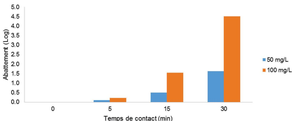
**Figure III.1: influence de la concentration en H<sub>2</sub>O<sub>2</sub> (50 et 100 mg/L) sur l'abattement d'une souche d'*E. coli* sauvage dans l'eau du réseau.**
