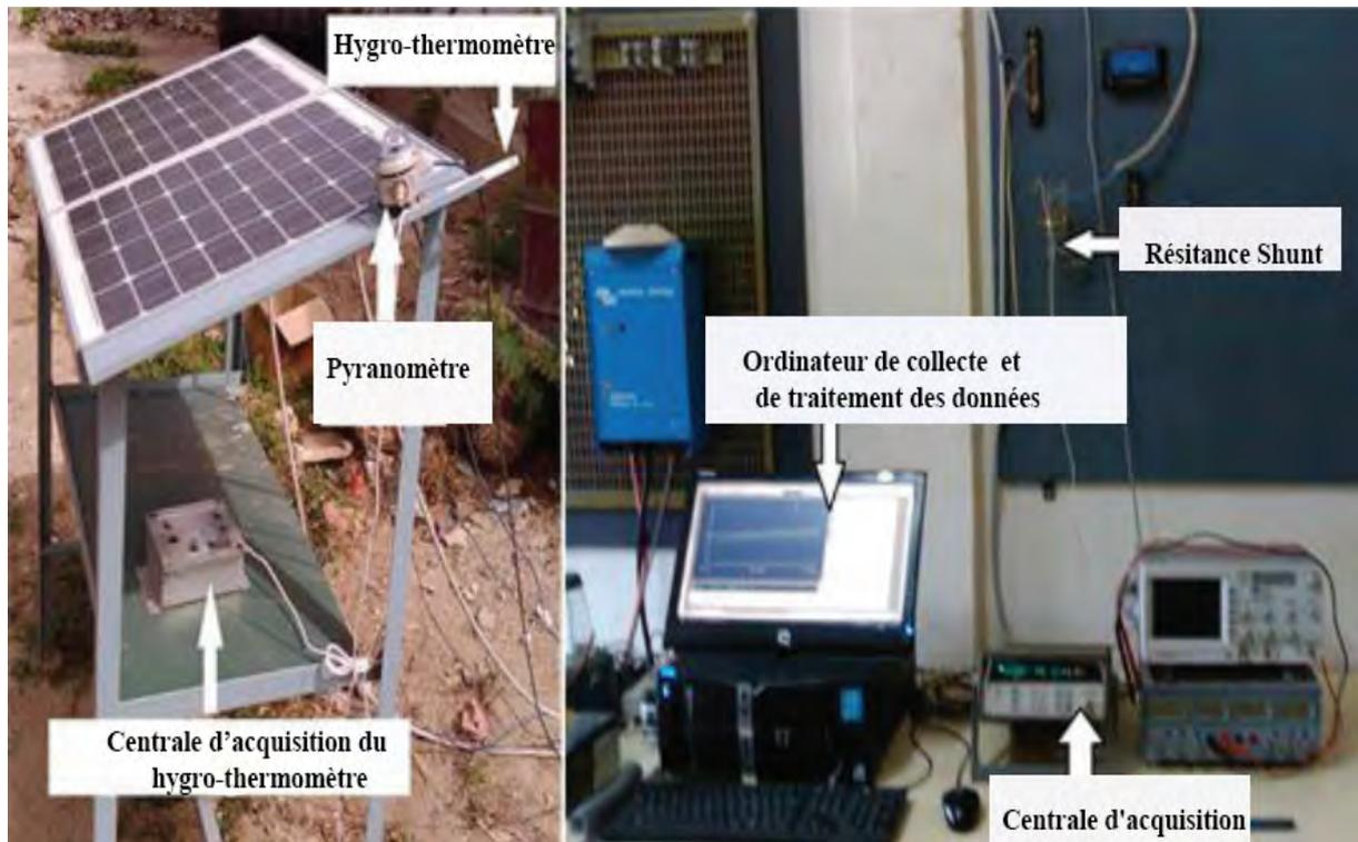
FIGURE 3.2 – La plateforme de mesure du CIFRES.
