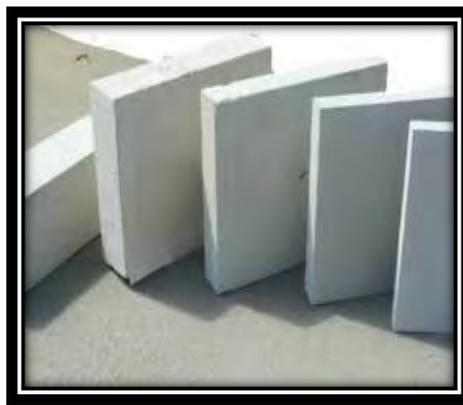
*Figure 5 : Brique de plâtre*
