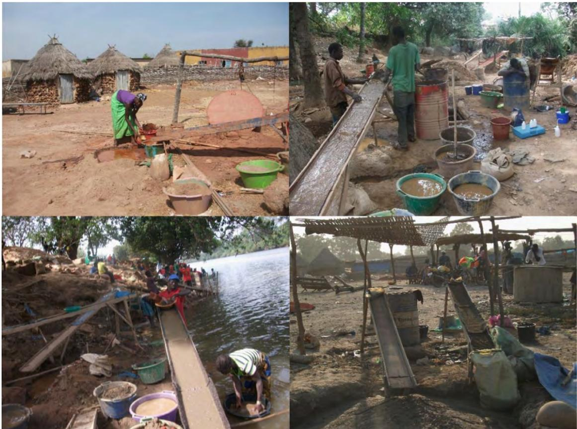
Photo 15. Lavage du minerai au niveau de différents points d'eau (photo Mall, 2011)
