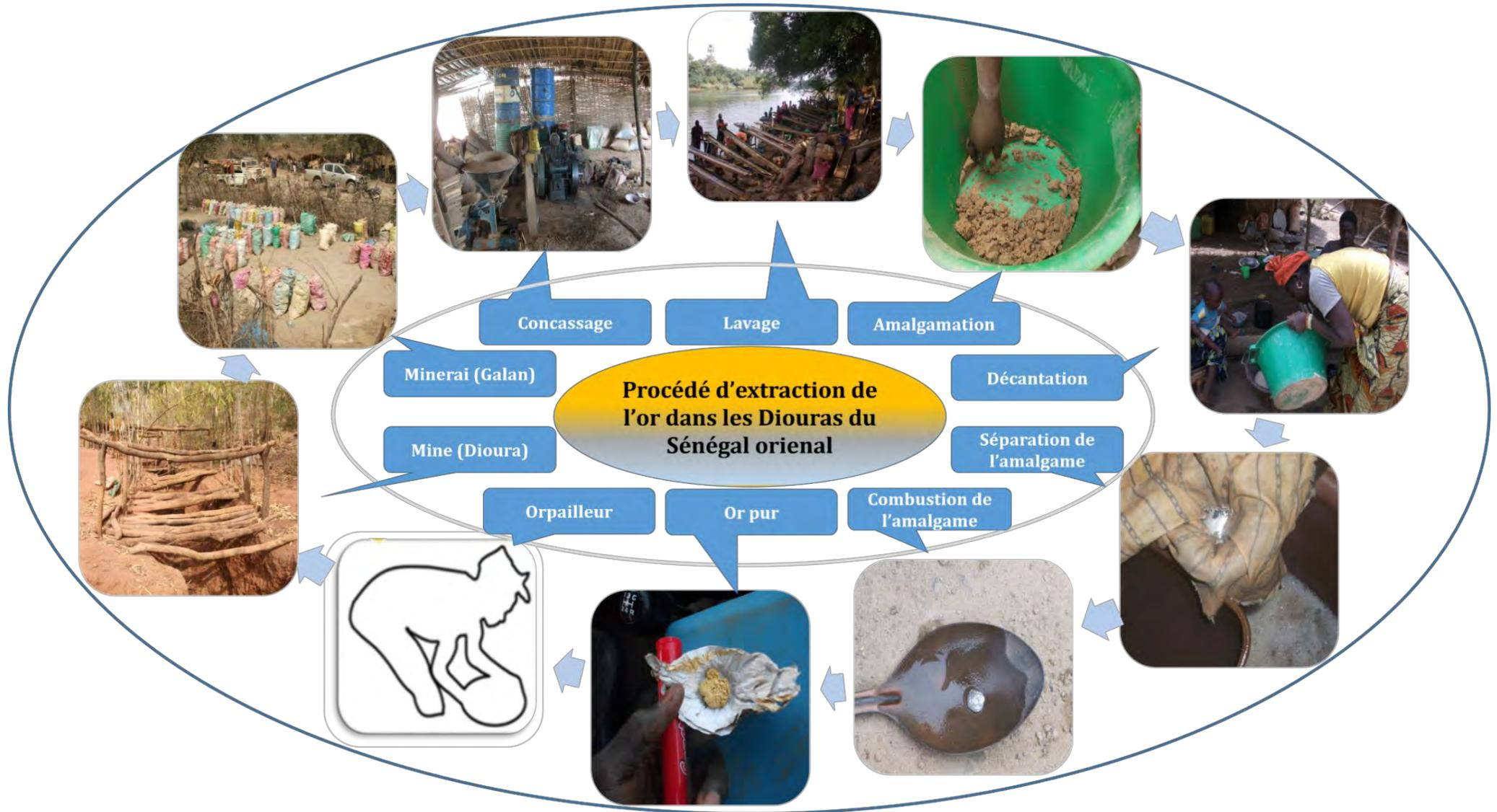
Figure 87. Procédés de traitement du minerai dans l'orpaillage et l'exploitation minière à petite échelle (photo Mall)
