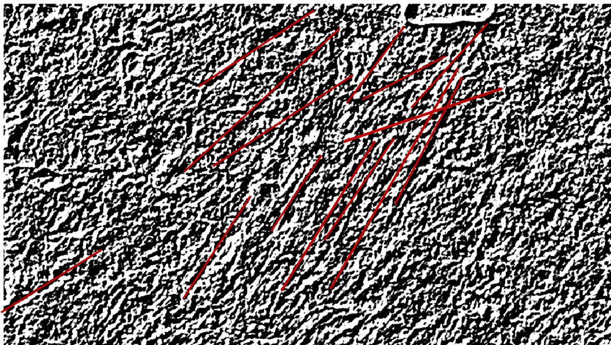
Figure 37. Filtre directionnel Sobel NO-SE qui met en évidence les linéaments NE-SO
