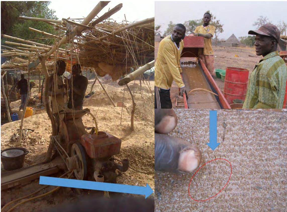
Photo 14. Le lavage du minerai avec le Trommel et sur placette couverte d'une moquette retenant les pépites d'or encerclées en rouge (photo Mall).
