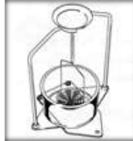
La masse volumique déterminée à l'aide de cette balance utilise le principe d'Archimède. En effet, un solide immergé dans un liquide est soumis à la force appelée poussée hydrostatique. La valeur de cette force est égale au poids du volume du liquide déplacé par l'échantillon (solide).
