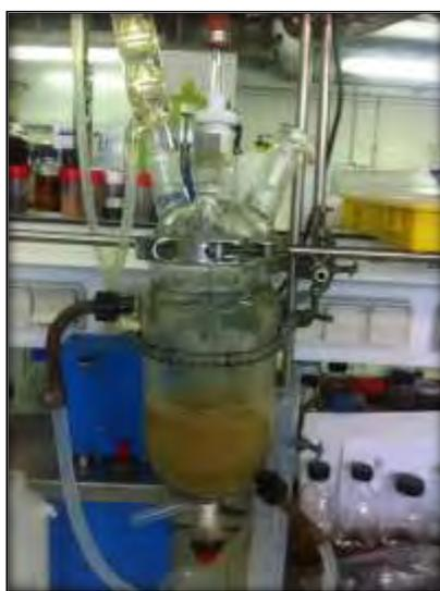
**Figure V-2** : Photo du réacteur utilisé pour l'extraction de l'azadirachtine au solvant
