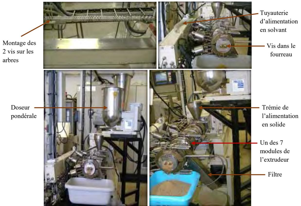
**Figure III-2 :** Photos de l'extracteur bi-vis de type Clextral BC 21
