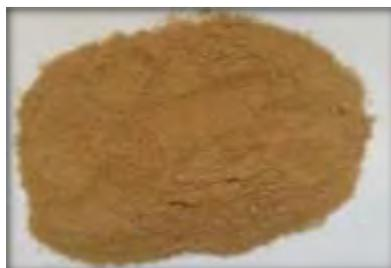
**Figure IV-5 :** Photographie de l'extrudât obtenu par procédé de fractionnement aqueux des graines de neem en extrudeur bi-vis de type Cleextral BC 21
