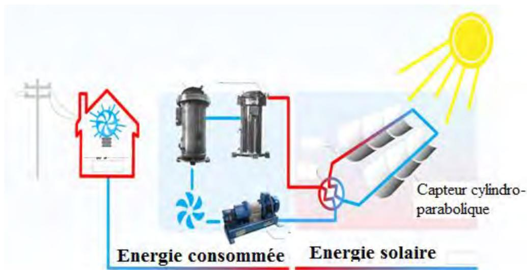
*Figure 3.3 : microcentrale Sun2Power de 2,5 kW utilisant des capteurs cylindro-paraboliques et une machine ORC*
