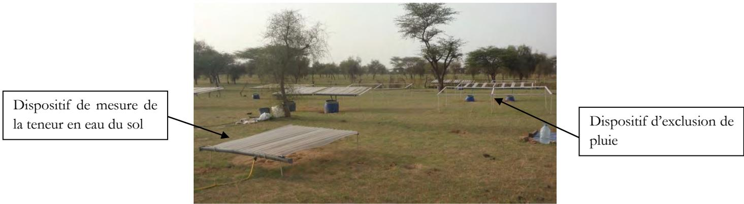
**Figure 30 :** Parcelle d'expérimentation du dispositif d'exclusion de pluie et dispositif de mesure de la teneur en eau du sol
