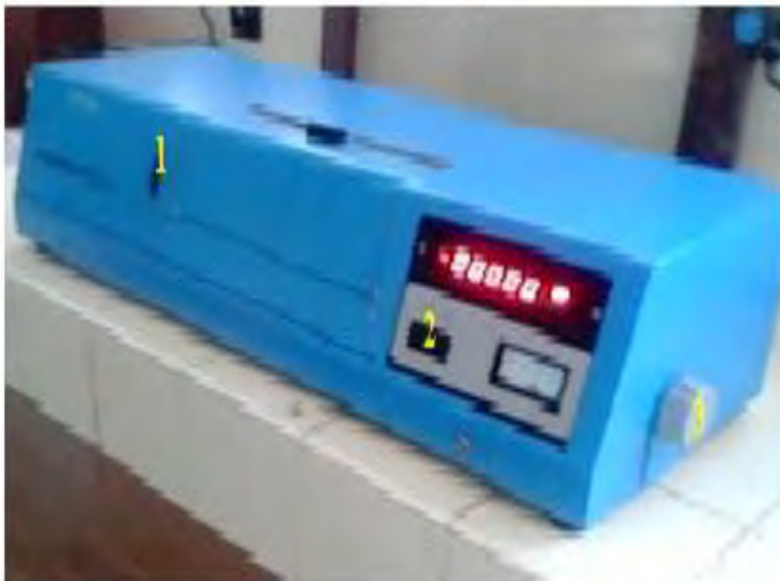
Figure 13. Polartronic E avec une cuve de longueur 5 cm.
