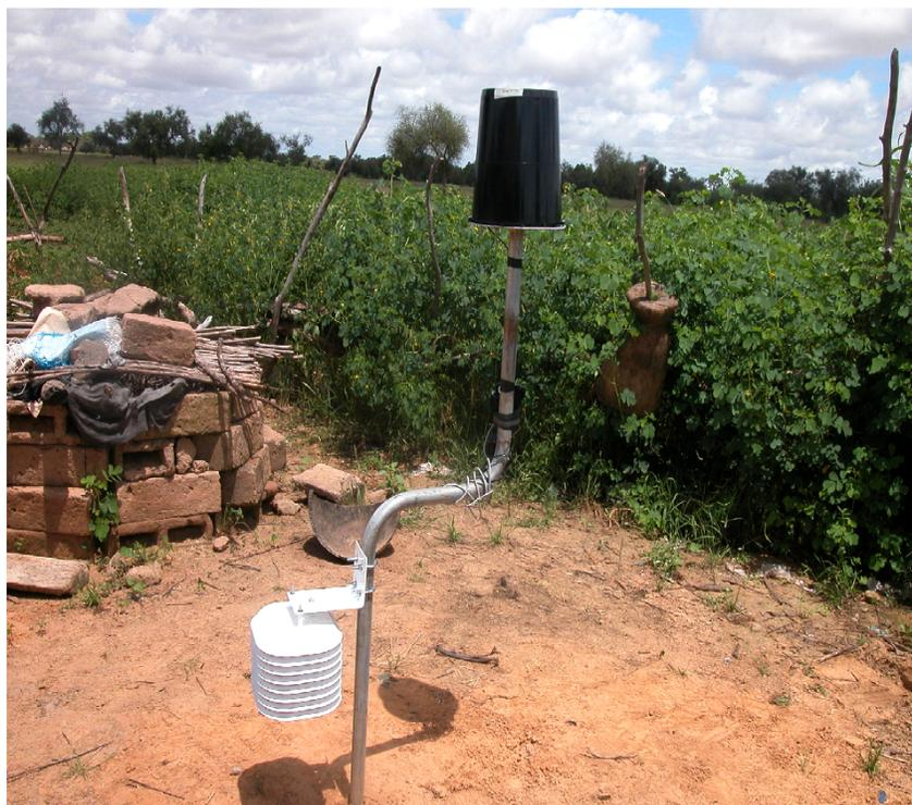
Figure 7 : Station météorologique pour la mesure de la pluviométrie, la température et l'humidité
