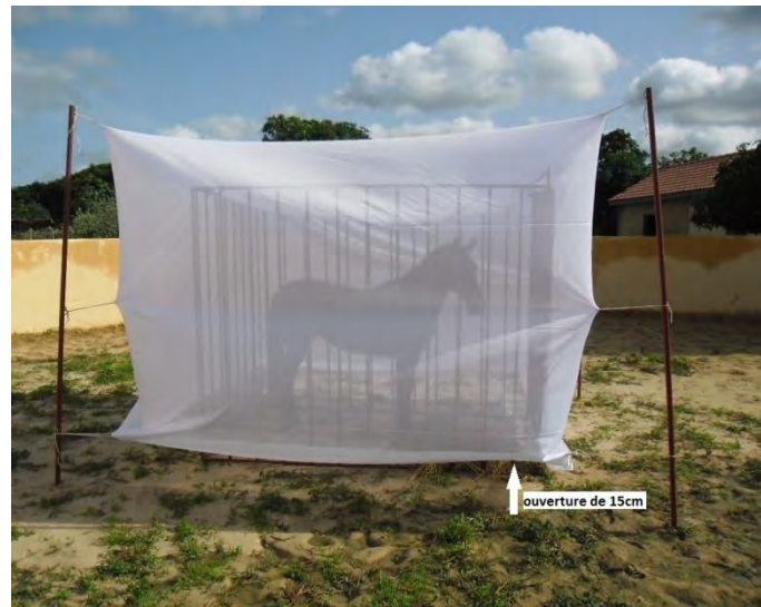
Figure 11 : Description du piège à appât cheval utilisé au cours de notre étude (cliché : Michel Ange DUSOM 2011)
