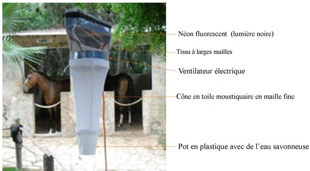
Figure 8 : Description des pièges OVI utilisés au cours de notre étude (cliché : Michel Ange DUSOM 2011).
