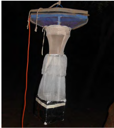
Figure 10 : Piège OVI adapté pour capturer des Culicoides vivants (cliché : Moussa FALL 2013).
