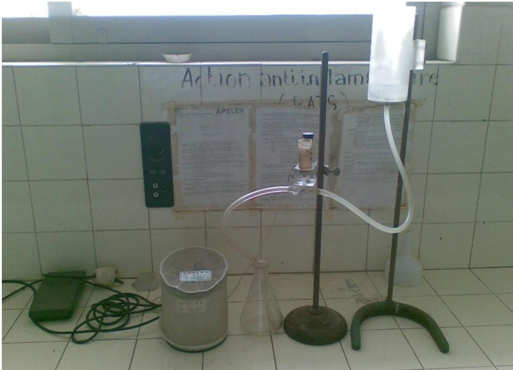
**Figure 16:** Pléthysmomètre APELEX 05-7150.
