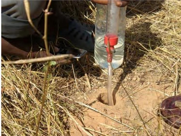
**Figure 19. Mesure d'indice d'infiltration de l'eau**
