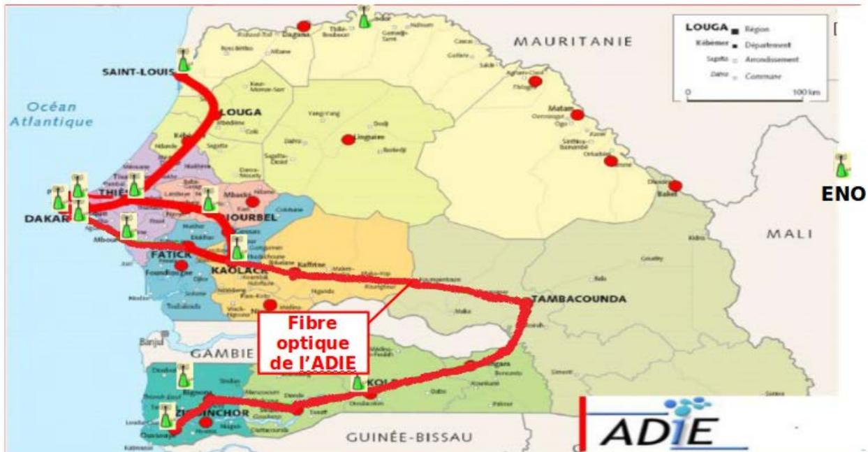
FIGURE II.1.11 – Cartographie du réseau Fibre optique de l'ADIE
