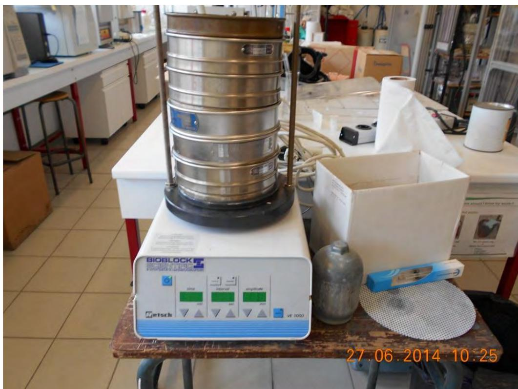
**Photo 3** : Granulomètre BIOBLOCK par tamisage (Source : Auteur)
