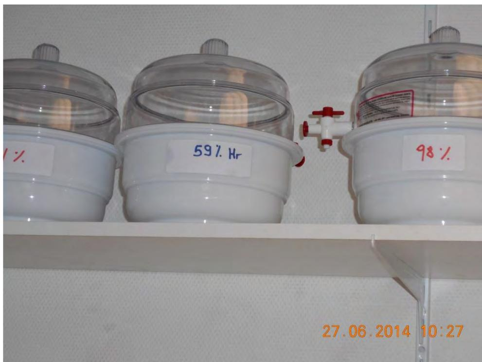
**Photo 4 :** Test d'humidité relative (Source : Auteur)
