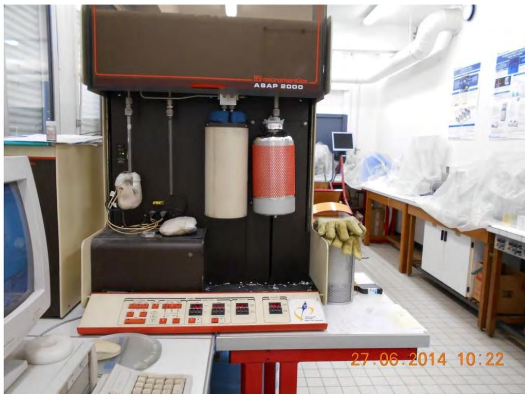
**Photo 1** : Appareil ASAP 2010 pour la détermination des isothermes d'adsorption (Source : Auteur)
