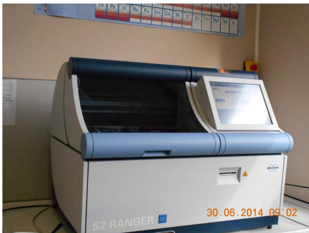
**Photo 5 :** Spectromètre à fluorescence X type BRUKER S2 RANGER (Source : Auteur)
