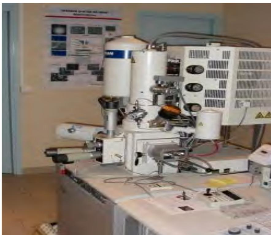
**Photo 10** : Microscope électronique à balayage (Source : Centre Commun de Microscopie de Lille)
