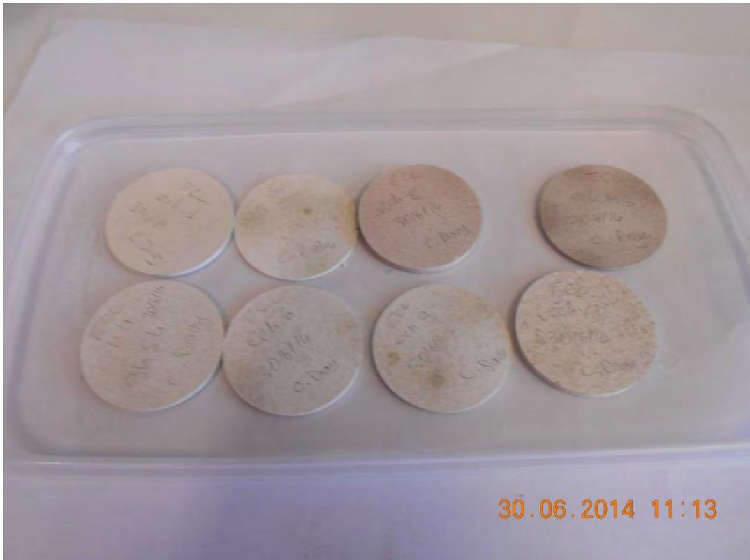
**Photo 6** : Pastilles d'échantillons pour l'analyse au spectromètre à fluorescence X (Source : Auteur)
