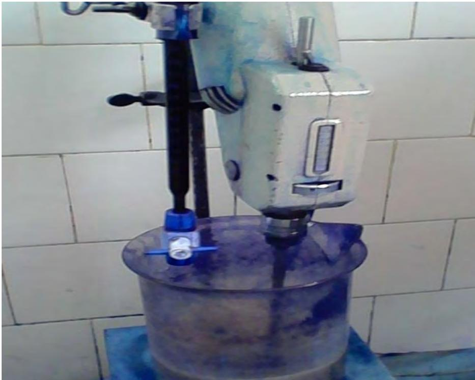
**Photo 12** : Test au bleu de méthylène (Source : Auteur)
