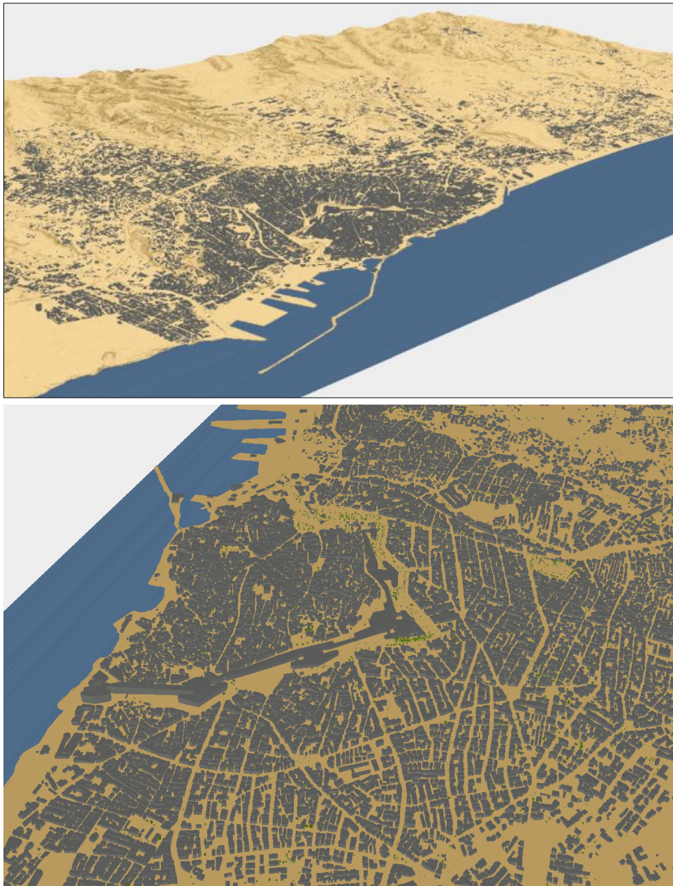
Figure 4.9 : Maquette DART de la ville d'Héraklion, en vue oblique, affichée par l'outil de visualisation 3D de DART. En vert la végétation, en gris foncé les bâtiments, en bleu l'eau, et en beige le relief. En haut : vue globale. En bas : zoom sur le centre-ville.
