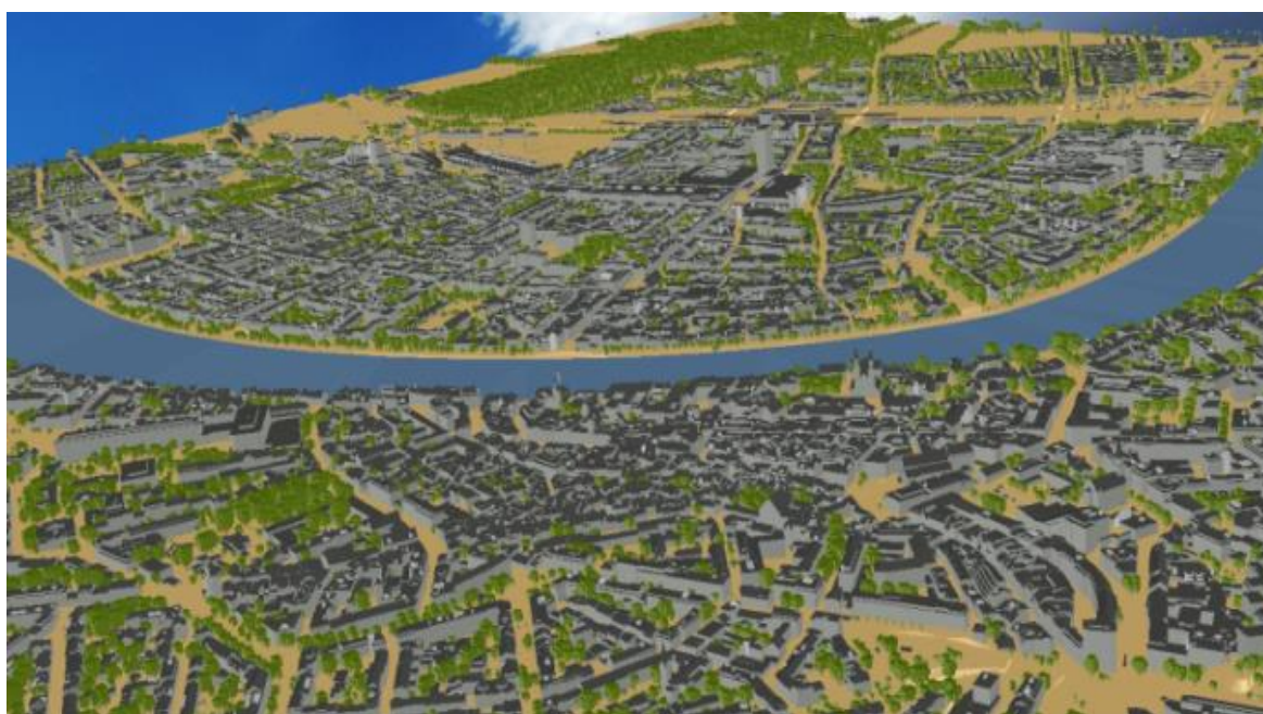
Figure 4.3 : Maquette DART de la ville de Bâle, en vue oblique dans l'outil de visualisation 3D de DART. En vert la végétation, en gris foncé les toits, en gris clair les murs, en bleu l'eau, et en beige le relief.
