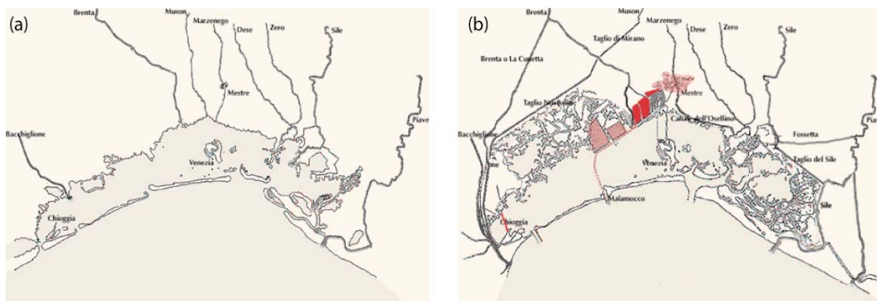
Figure II.3 : (a) Lagune en 1300 : 8 embouchures sont présentes et la majorité des fleuves du bassin versant se jettent dans la lagune ; (b) Lagune à la fin du 19 ème siècle : la plupart des cours des fleuves principaux ont été déviés, le littoral a été renforcé par la construction de digues et des trois jetées des embouchures du Lido, Malamocco et Chioggia, de gros travaux d'aménagements ont été effectués avec la construction d'infrastructures relatives au commerce et à l'industrie (Cartes originales publiées par l'organisme territorial « Consorzio Venezia Nuova » sur le site http://www.salve.it/it/default.htm ).
