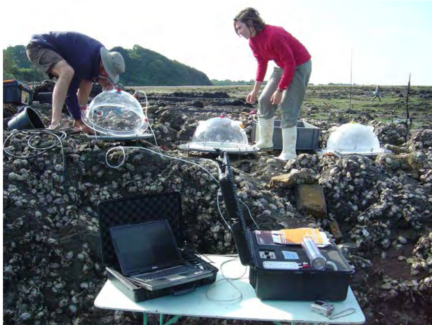
Figure III.12 : Les chambres benthiques transparentes sont reliées au dispositif d'analyse en circuit fermé.
