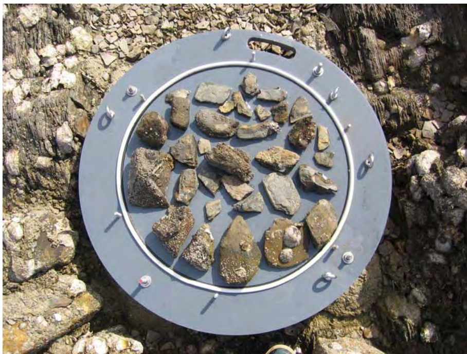
Figure III.11 : Echantillon placé sur les bases en PVC des enceintes benthiques fixées dans la roche au niveau de la zone intertidale.
