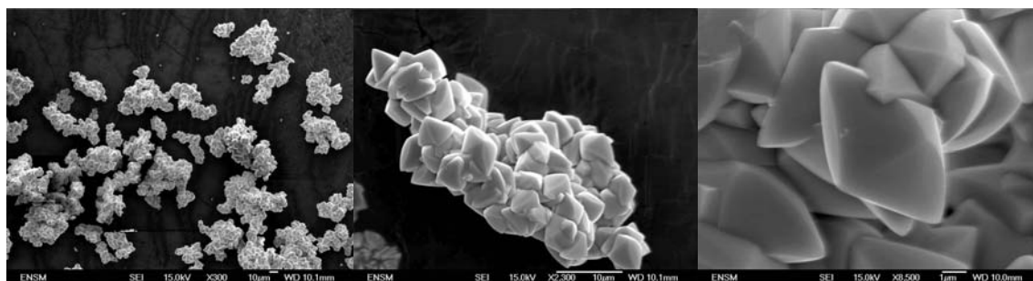
Figure 4.18- Photo MEB du \text{SrMoO}_4 obtenue en fin de précipitation pour C_0 égale à 8 \text{ mol.m}^{-3} (conditions de précipitation : 25^\circ\text{C} , 350 \text{ min}^{-1} , hélice Mixel TT).
