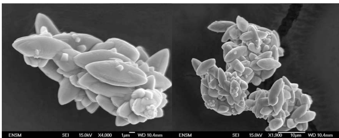
Figure 4.10- Photos MEB du \text{SrMoO}_4 en fin de précipitation obtenue à 500 \text{min}^{-1} (conditions de précipitation : 25°C, 25 \text{mol.m}^{-3} , hélice Mixel TT).
