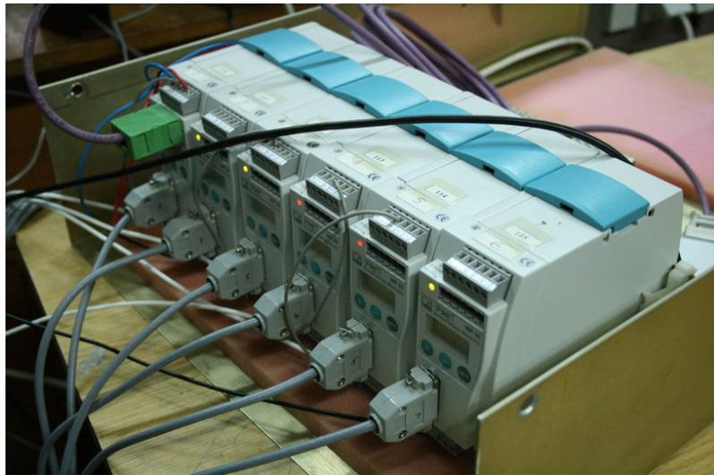
**Figure 5.8.** Photo des amplificateurs des capteurs de force
