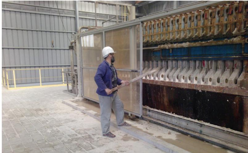
Figure 14 : Opérateur libère les tourteaux qui restent collés sur les toiles de filtration
