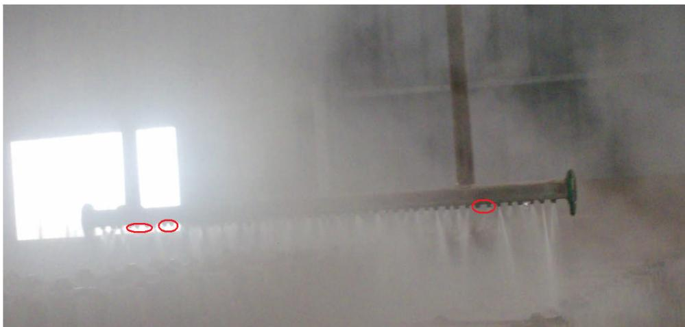
Figure 12 : Pont laveur effectuant le nettoyage des toiles. Les cercles rouges représentent les buses colmatées
