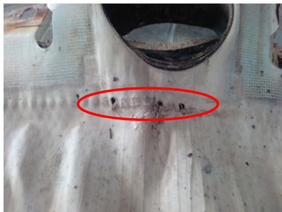
**Figure 9 : Les trous permettant le passage de la boue entre le plateau et la chambre**
