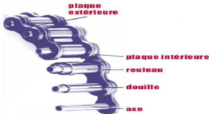
Figure 10: Chaîne à rouleaux simple
