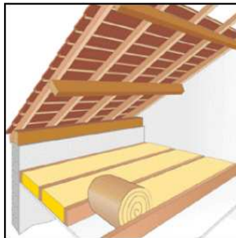
Figure 1.21 : isolation des faux plafonds
