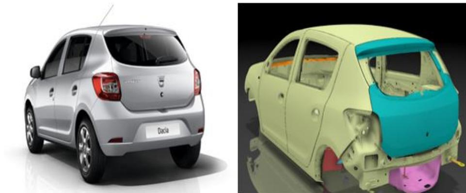
**Figure 86 : Panneaux inférieur et supérieur sur la Dacia Sandero**
