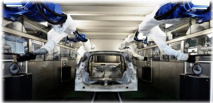
**Figure 7 : Processus de peinture robotisé**
