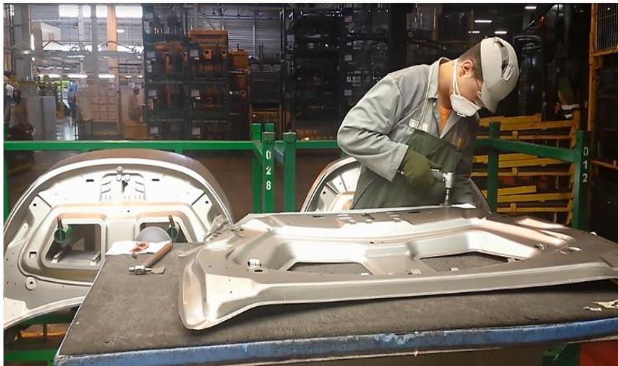
Figure 46 : Retouche d'une doublure de capot (Renault Tanger)
