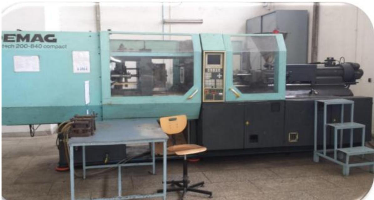
Le rôle de la machine est la production des différentes parties du boîtier du compteur monophasé ou triphasé. Chaque machine comporte un moule permettant la mise en forme de la pièce désirant (la base, le capot, et le bloc à bornes...).
