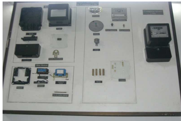
Figure 3: Les pièces constitutives du compteur monophasé 2 fils
